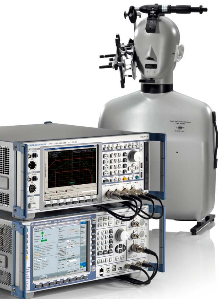
使用R&S®CMW500结合 R&S®UPV音频分析器分析音频。
