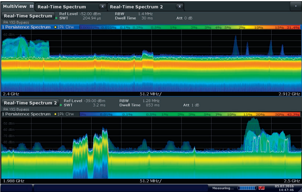
凭借 R&S®FSW 的 MultiView 功能，高于和低于 2.4 GHz ISM 频段的 512 MHz 余辉频谱可同时显示。
