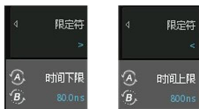
旋转旋钮A微调时间下限或上限，旋转旋钮B可粗调时间下限或上限
