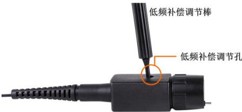
图 5.7 探头补偿调节孔
