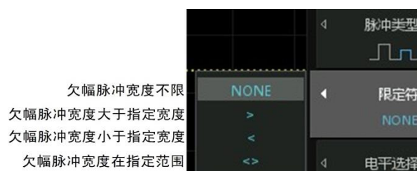
图 10.32 欠幅脉冲宽度限定
