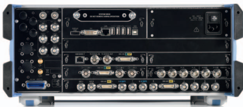
R&S®BTC的基本配置支持两路带实时调制的RF通道。基于这个配置，还可以配三个额外的硬件模块（可以是VTx模块也可以是BTC模块）
