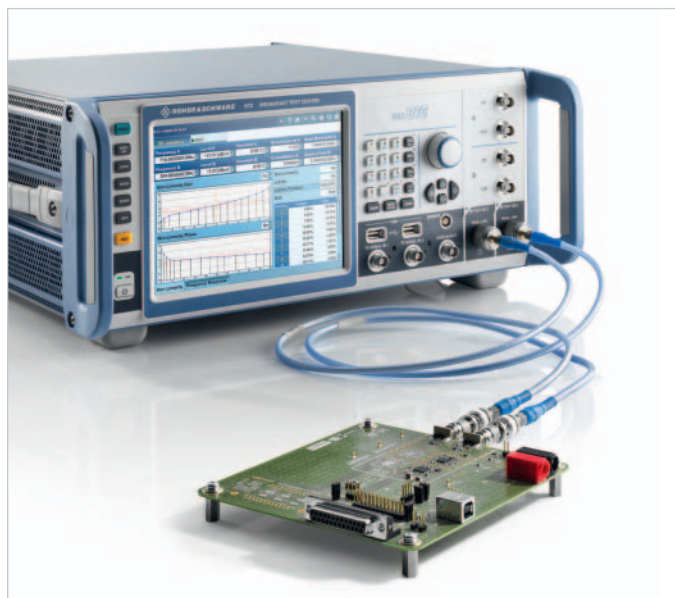
R&S®BTC与DUT连接示意图
