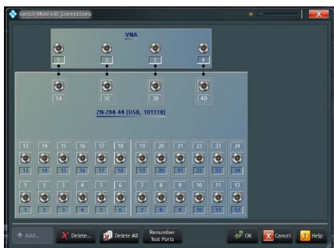
在R&S®ZNB中，自动分配测试端口。
